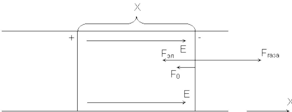
Рассмотрим проекцию равнодействующих всех сил, действующих, например, на правый поршень:
